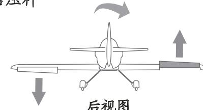
当您将发射机的右侧操纵杆⑤向右压杆时，飞机的右副翼向上，左副翼向下，此时飞机将向右滚转。
